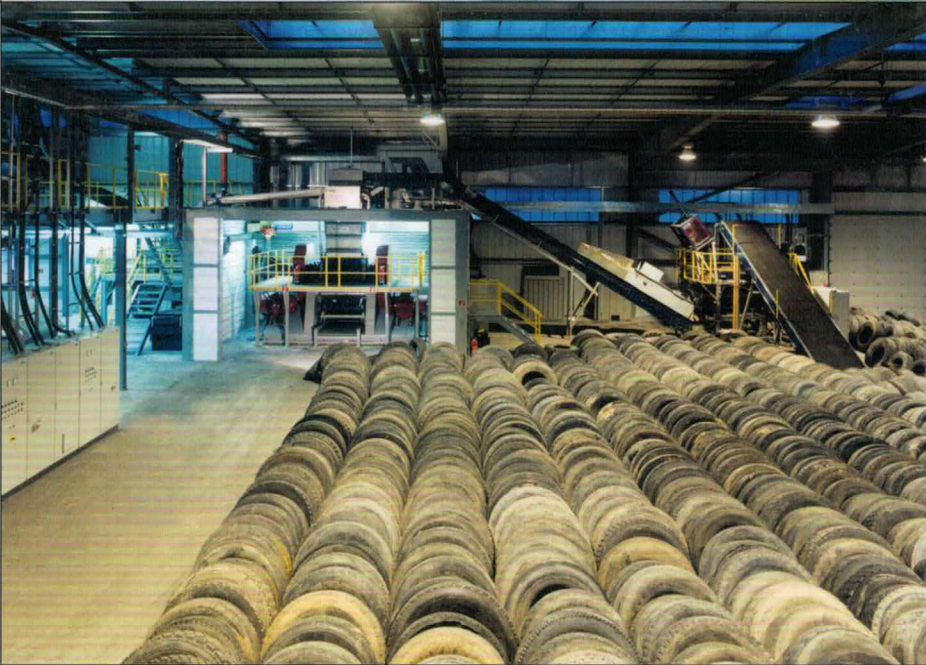
Schredder und Hauptmahanlage Spezielle Aufbereitungstechnik für LKW-Reifen
