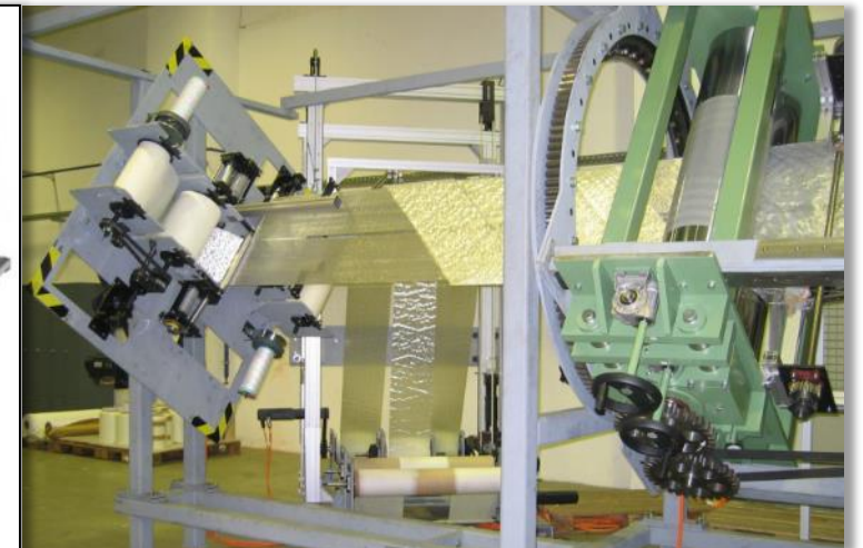
MD-Anlage: Herstellung multidirektionaler Halbzeuge
