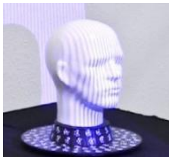
Antropometrische Messung mit Vialux-Scanner
