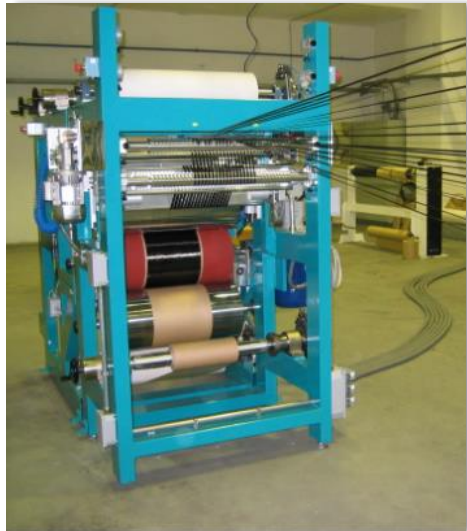
UD-Anlage: Herstellung unidirektionaler Fasergelegestrukturen aus Filamentbündeln
