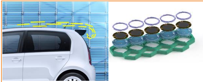
Active Strömungsbeeinflussung von aerodynamischen Strukturen
