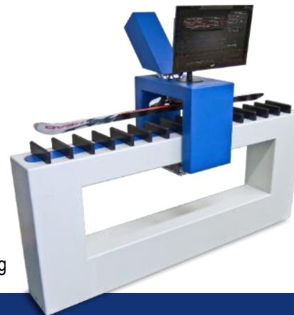
"Real Snow" Biegeprüfung
