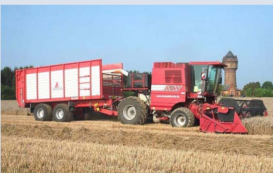
Mit diesem Kompaktmähdrescher kann Korn, Spreu und Stroh in einem Arbeitsschritt geerntet werden.
